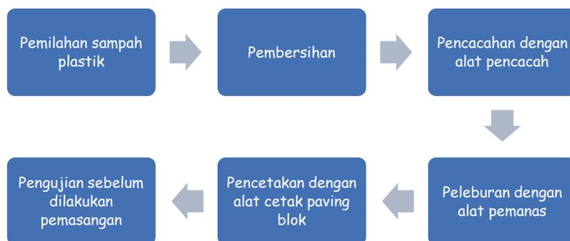
Gambar 8. Tahapan pengolahan sampah plastik menjadi paving blok
