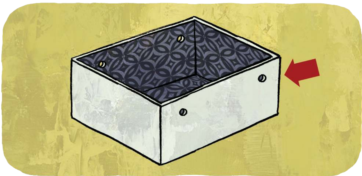
Gambar 4. Lubangi sisi badan mobil. Ukurlah dengan teliti.
